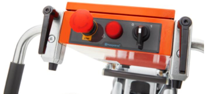
Die Geschwindigkeit ist fest eingestellt und es sind keine weiteren Einstellungen mehr erforderlich. Außerdem ist die Maschine mit einem benutzerfreundlichen, logischen Bedienfeld mit Überlastschutz ausgestattet.
